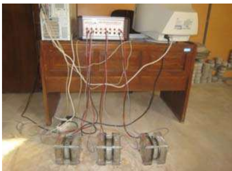
شکل ۵ - نمای شماتیک از دستگاه ثبت شار الکتریکی RCPT
