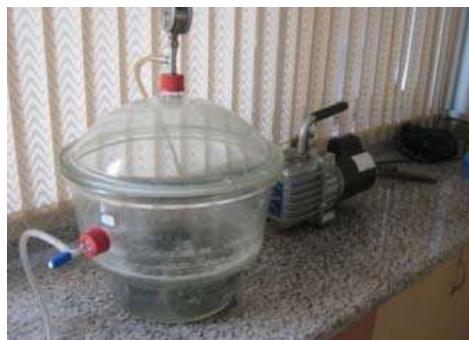
شکل ۴ - نمای شماتیک از پمپ خلاء آزمایش RCPT
